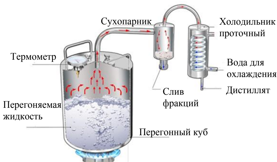
Рис. 3.21. Конструкция дистиллятора
