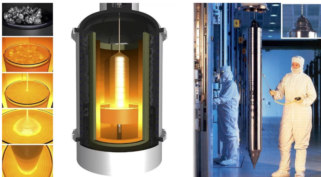
Рис. 3.49. Этапы роста монокристалла кремния и выращенный монокристалл кремния диаметром 400 мм
