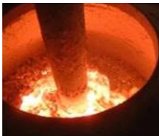
Рис. 4.10. Процесс получения технического кремния в дуговой печи
