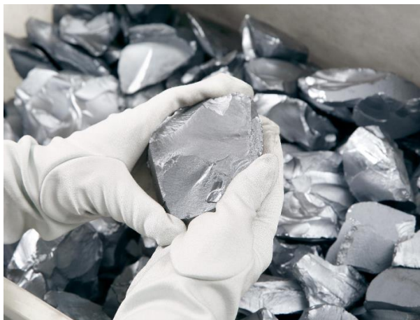
Рис. 4.14. Куски поликристаллического кремния перед загрузкой в тигель при выращивании монокристалла методом Чохральского
