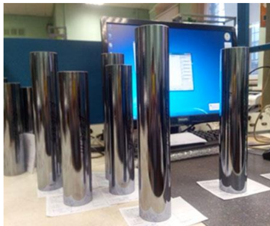
Рис. 4.15. Заготовки монокристаллического кремния перед операцией резки на пластины-подложки
