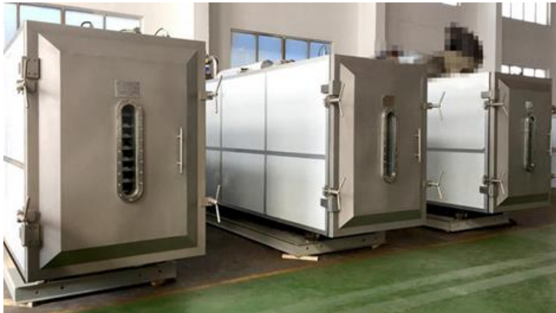
Рис. 3.14. Промышленные установки для лиофильной сушки в фармацевтике, марка LP500, фирма ilShin, Корея (500 – объем камеры в литрах)
