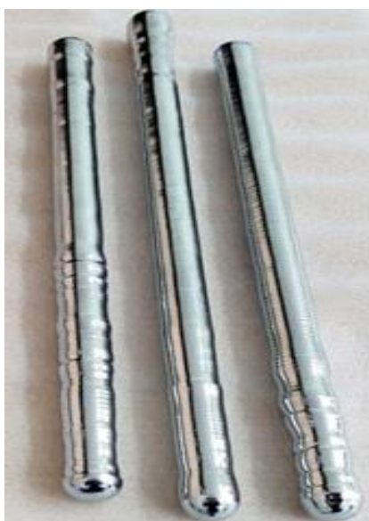
Рис. 3.50. Зонно-очищенные стержни молибдена (ФГУП НИИ НПО «ЛУЧ»)
