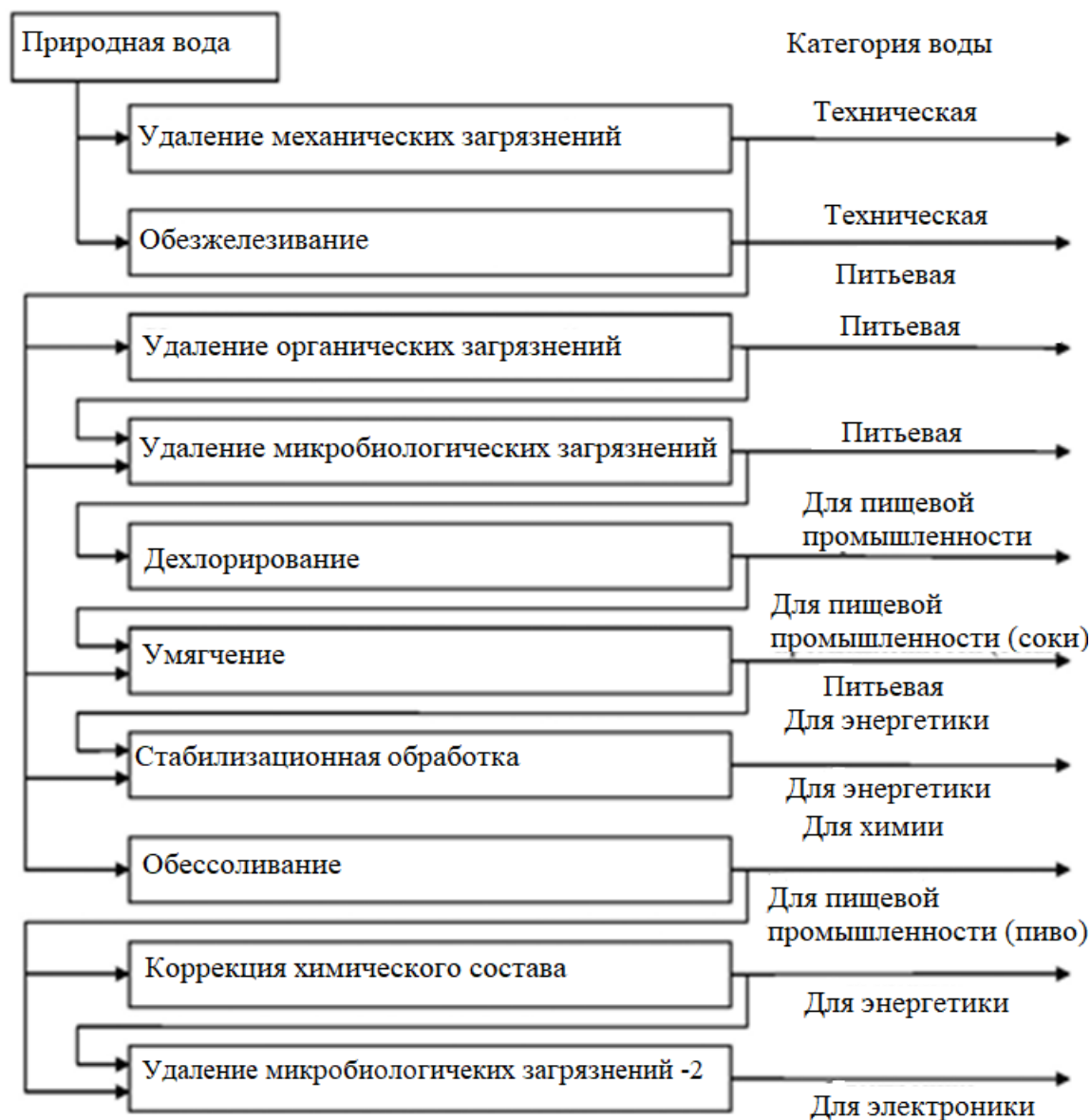
Рис. 4.1. Примерная последовательность стадий водоочистки и водоподготовки для различных областей человеческой деятельности
