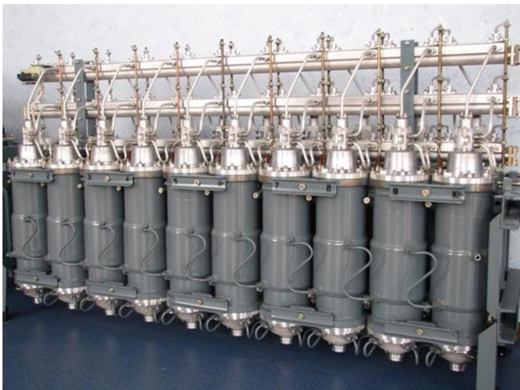
Рис. 3.53. Каскад газовых центрифуг для обогащения урана
