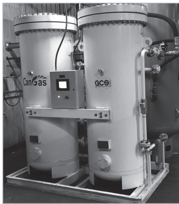
Рис. 1.36. Генератор азота CanGas, принцип работы которого основан на адсорбционном разделении воздуха
