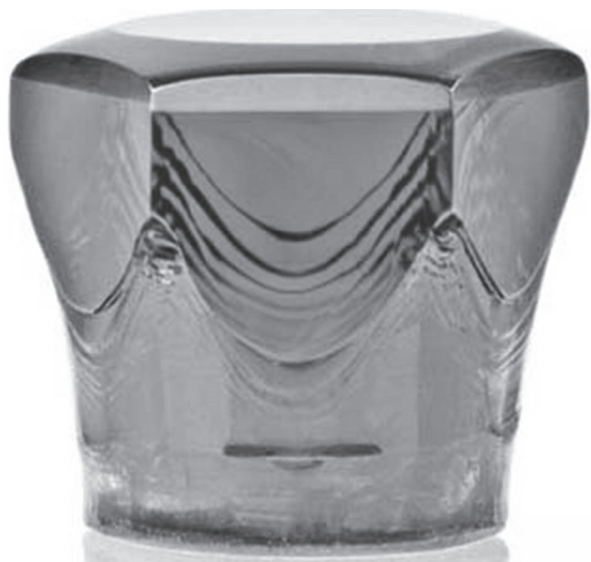
Рис. 1.40. Кристалл AlN диаметром 50 мм, выращенный методом сублимации–конденсации. "Hexatec Inc.", Моррисвилль, Северная Каролина, США. Затравка расположена снизу, кристалл ограничился в процессе роста призматическими и пирамидальными гранями
