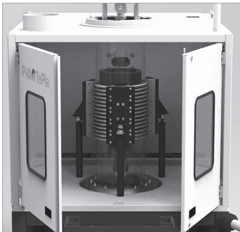
Рис. 1.18. Оснастка реактора с ВЧ-индуктором установки basic-T для выращивания монокристаллов карбида кремния модифицированным методом Лели (методом ЛЭТИ), фирма "PVA TePla AG", Германия
