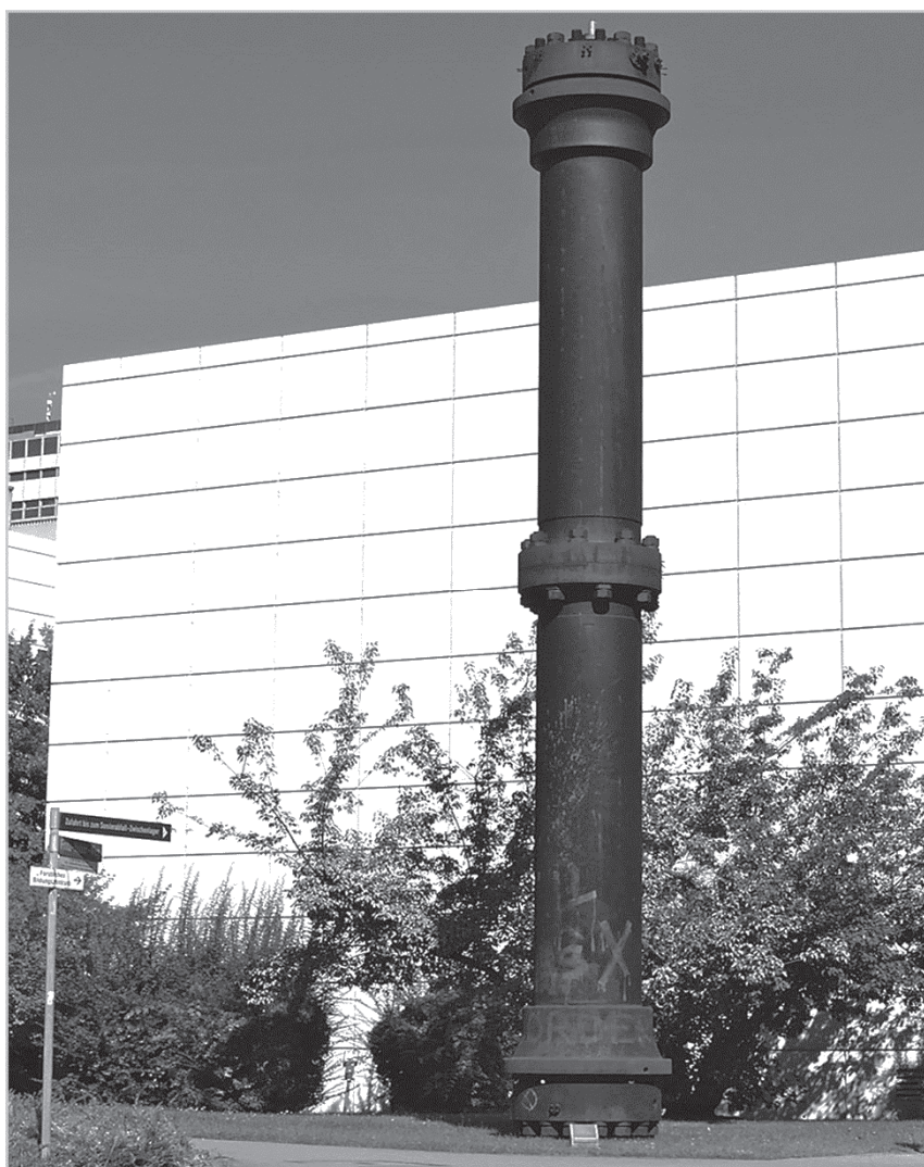
Рис. 1.39. Исторический реактор высокого давления для производства аммиака. Построен в 1921 г. для компании "Badischen Anilin- und Sodafabrik AG (BASF)", Людвигсхафен-на-Рейне, Германия. Экспонируется в Техническом университете Карлсруэ
