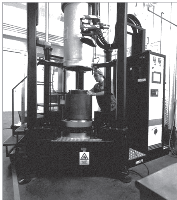
Рис. 1.22. Схема выращивания кристаллов GaAs методом Чохральского с жидкостной герметизацией расплава (LEC) (а); установка для выращивания кристаллов GaAs по методу Чохральского с жидкостной герметизацией расплава (LEC) диаметром 101,6...152,4 мм, фирма "Compound Crystal Technology Co.", КНР(б)
