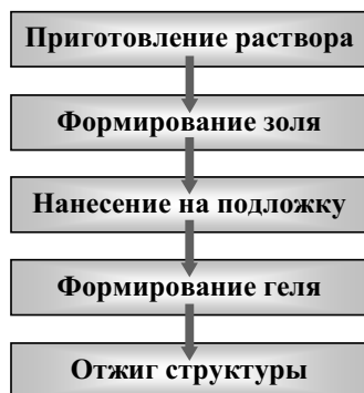
Рис. 5.25. Последовательность операций при создании пленочных структур методами золь-гель технологии
