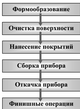
Рис. 3. Технологический маршрут изготовления вакуумных приборов
